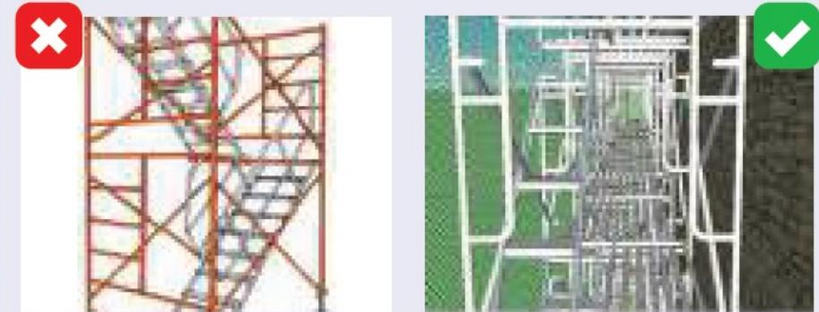
Untuk bangunan perancah, dipasang pipa penunjang tiap 3 bagian yang terpasang pada pipa horizontal.
