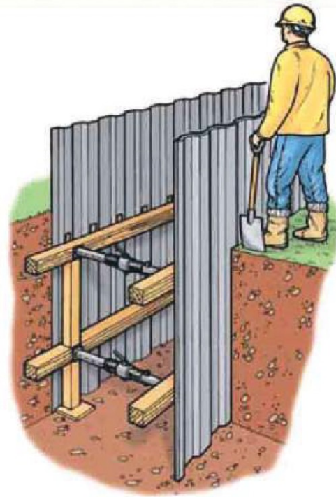
Turap galian dengan dinding kayu, sekrup penopang, tonggak dan bantalan
